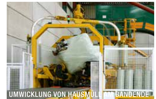
BEREICH FÜR ENTGEGENNAHME AM BANDENDE UND BALLENPRESSUNG VON WERTSTOFFEN UND HAUSMÜLL
