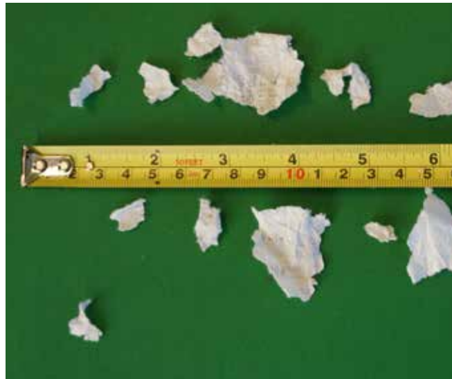
ZERKLEINERER MAC 1500 D GRIDS 38 MM
