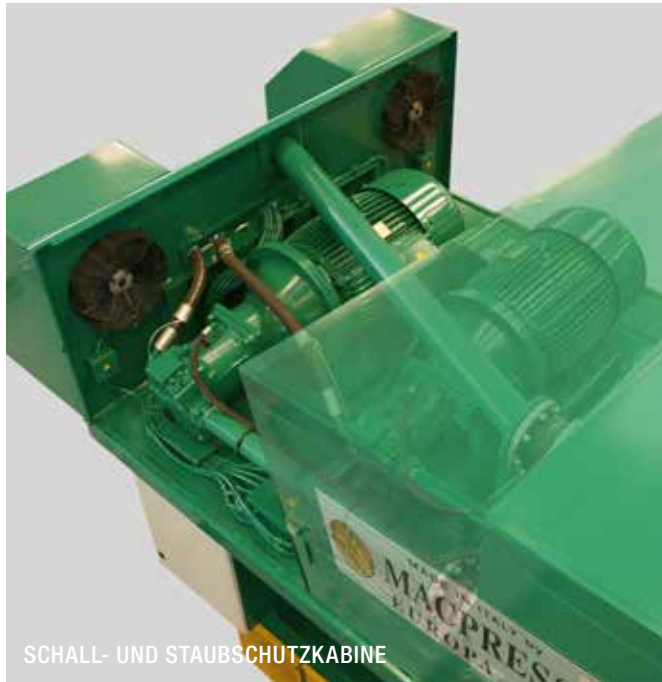
INSPEKTIONSDECKEL FÜR DIE REINIGUNG UND WARTUNG
