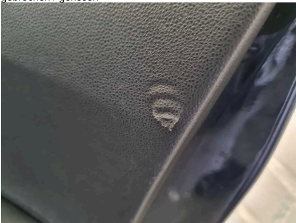
Beschädigung #6: Verkleidungen/Abdeckungen: Verkleidungen/Abdeckungen - verkratzt / verschürft - -
