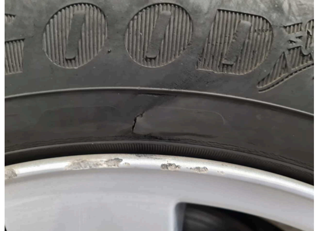
Beschädigung #1: Rad/Reifen: Reifen vorn links - gebrochen / gerissen - -
