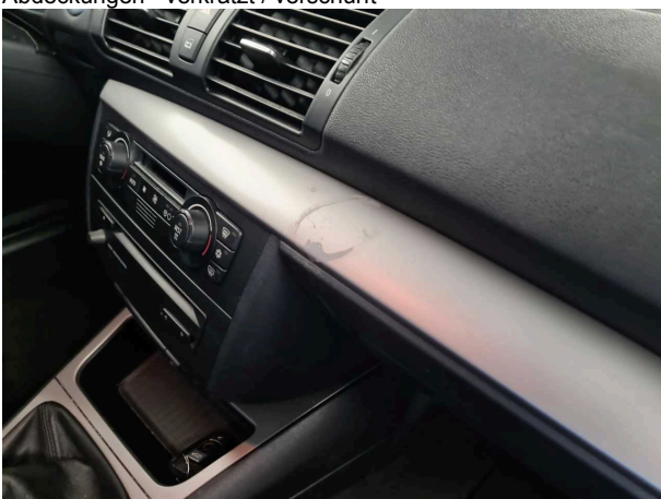
Beschädigung #6: Verkleidungen/Abdeckungen: Verkleidungen/Abdeckungen - verkratzt / verschürft - -
