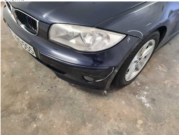
Beschädigung #4: Stossfänger vorn: Stossfänger vorn - verkratzt / verschürft - -
