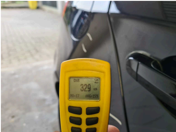
Nacklackierung 1: Motorhaube, Seitenwand rechts
