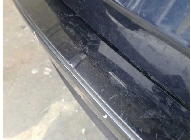
Beschädigung #3: Stossfänger hinten: Stossfänger hinten - verformt - -
