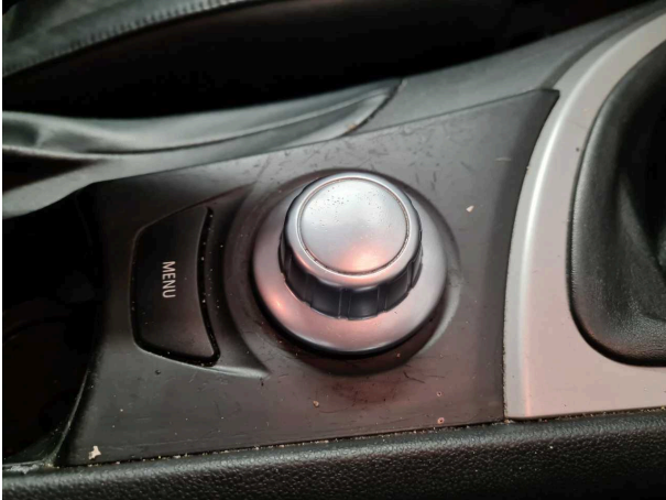
Beschädigung #6: Verkleidungen/Abdeckungen: Verkleidungen/ Abdeckungen - verkratzt / verschürft - -
