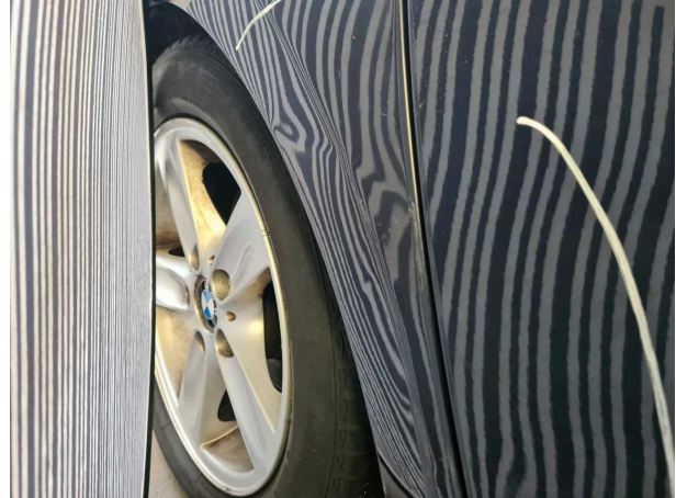
Beschädigung #7: Seitenwand rechts: Seitenwand - Delle / Lackschaden - -
