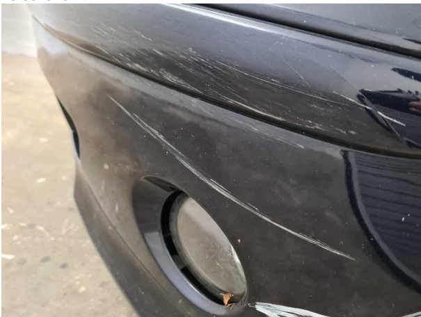
Beschädigung #4: Stossfänger vorn: Stossfänger vorn - verkratzt / verschürft - -
