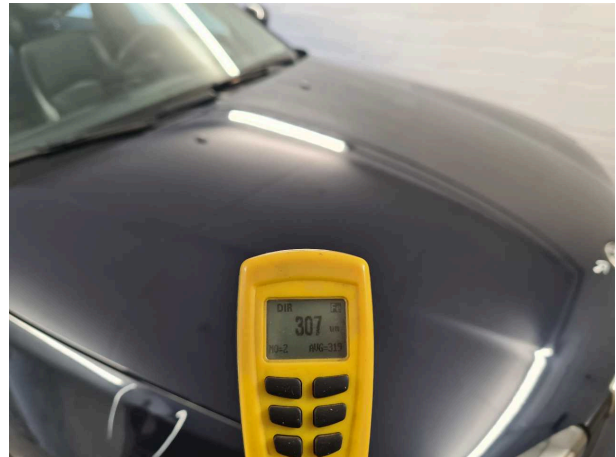
Nacklackierung 1: Motorhaube, Seitenwand rechts
