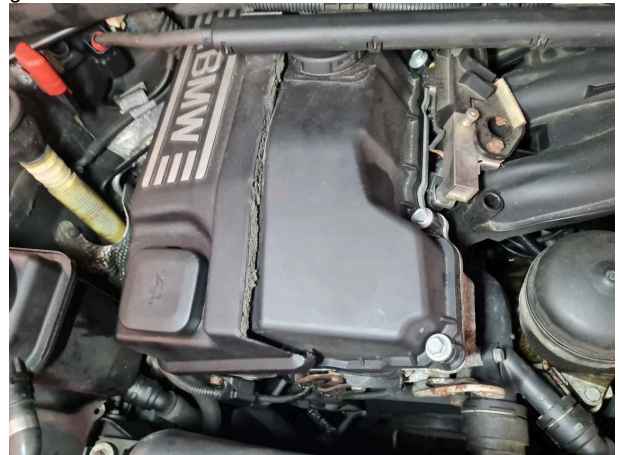
Beschädigung #2: Motor: Motor (Leichter Ölverlust) - undicht - -
