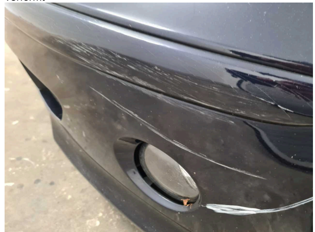
Beschädigung #4: Stossfänger vorn: Stossfänger vorn - verkratzt / verschürft - -
