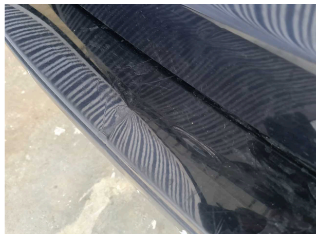
Beschädigung #3: Stossfänger hinten: Stossfänger hinten - verformt - -
